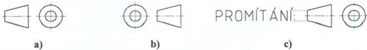
Obr. 3.2 a) Značka promítání metodou 1. kvadrantu - na výkresech určených k použití v ČR, nebo EU ji není nutno uvádět. b) Značka promítání metodou 3. kvadrantu (používaného např. v USA) c) Velikost značky se řídí velikostí textu ve kterém je použita
